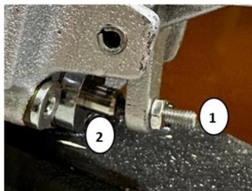
Bei der Montage der Griffstange, ist darauf zu achten, dass die Gewindeschraube (1) in der „Hebe“-Position der Hydraulikeinheit **nicht** den Ventilbolzen (2) blockiert und die Schraube leicht anliegt. Anschließend kann die Kontermutter mittels eines Schraubenschlüssels fixiert werden.
